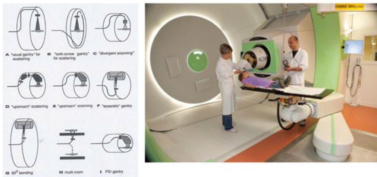
Рис. 7.3 – Типы установок гантри (слева) и общий вид одной из них (справа) в Институте им.М.Кюри
