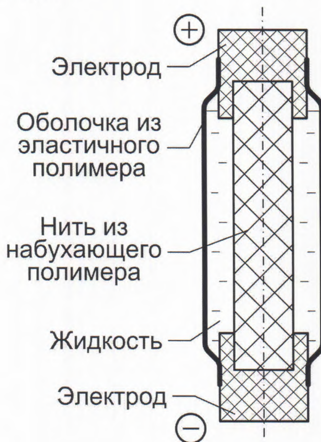
Рисунок 4. Схема исполнительного устройства на набухающих полимерах «искусственная мышца»
